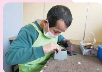
基板取り出し作業
